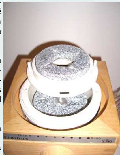
Habitáculo y piedras encajadas en aros de polipropileno en un molino KoMo modelo Fidibus Classic .
