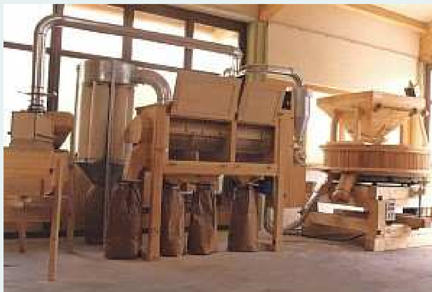
Molino industrial con separador de harinas. Las piedras de corindón se encuentran encajadas en PP y exteriormente están recubiertas por madera.
